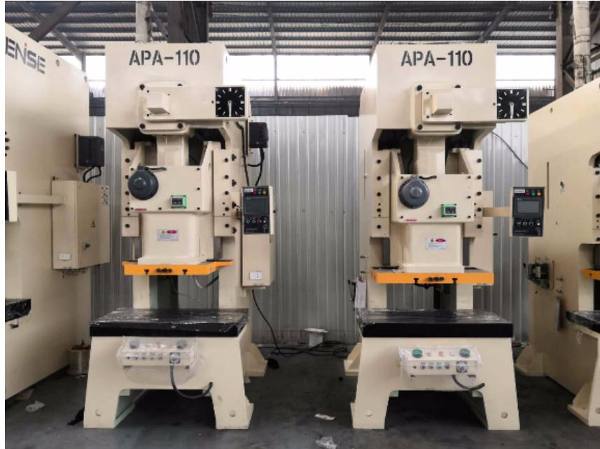
冲床在单侧裁切的全过程中，原料、模座和型腔都是造成个纵向力水准作用力，这一纵向力会造成原料晃动、齿面间娘扩大、裁切精神分析疗法堡降低等负面影响。因此在设计方案冲压模时除了结构类型要到合理对策来避免纵向力产生的负面影响比如模座、型腔反侧压构造或设备，在选择齿面空隙时，针对单侧裁切齿面的空隙，一般取一切正常空隙的30%-50%冲床，就是一台冲压式压力机。在国民生产中，冲压工艺由于比传统机械加工来说有节约材料和能源，效率高，对操作者技术要求不高及通过各种模具应用可以做出机械加工所无法达到的产品这些优点，因而它的用途越来越普遍；
